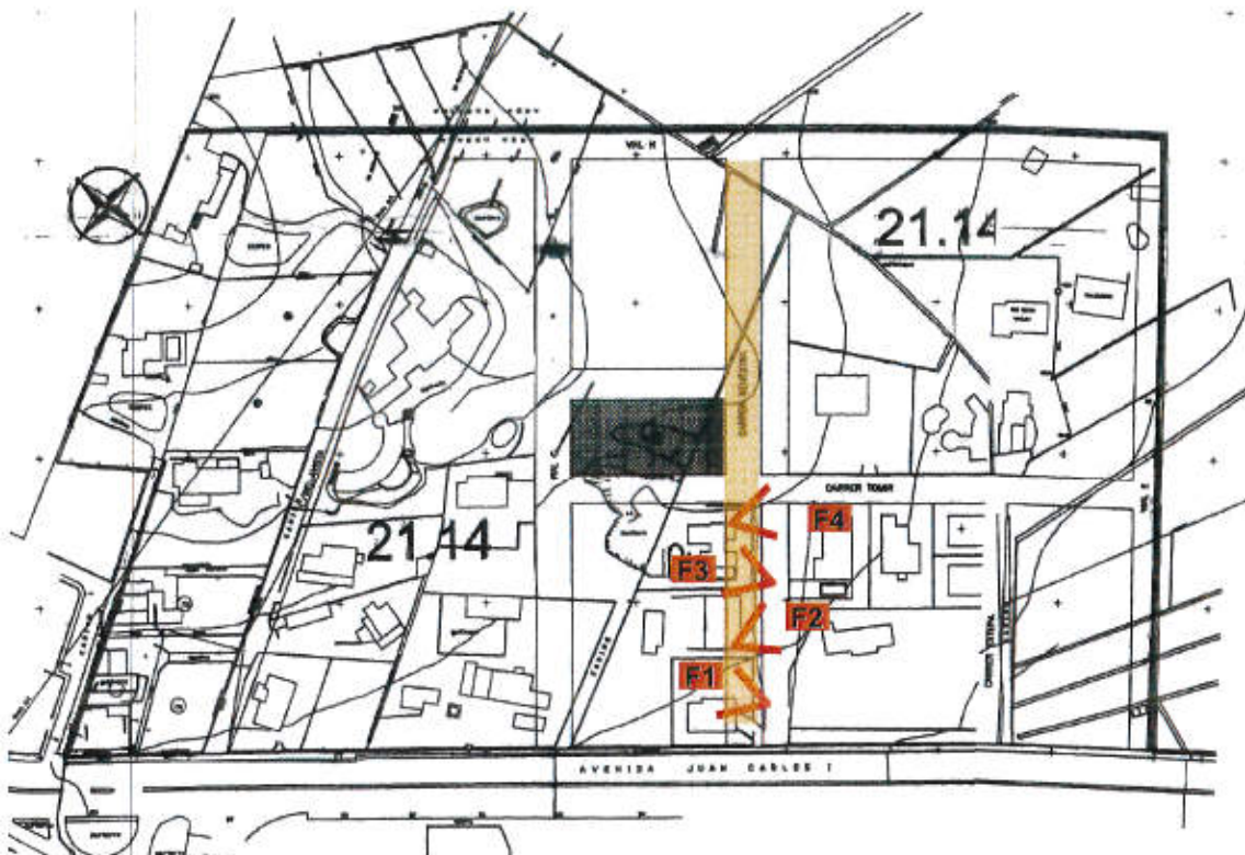
Plànol 1. Unitat d'actuació de Son Moll de Dalt. Superposició del plànol topogràfic i els plànols 19.4 i 19.5 de les vigents NNSS (1986).
